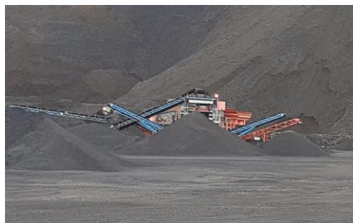
Mynd 2 Hljóðgjafi 1: Sandvik 440 kónbrjótur og VSI Sandvik RT 107 kastbrjótur keyrðir saman.
